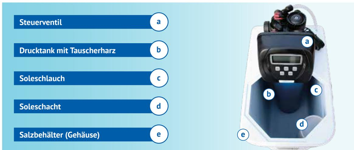
Ihre Enthärtungsanlage arbeitet mit dem Ionentauscherverfahren. Ein spezielles Tauscherharz entfernt dabei die Calcium- und Magnesium-Ionen zunächst komplett aus Ihrem Trinkwasser. Falls Sie sich dazu entscheiden eine gewisse Resthärte im Wasser zu belassen, können Sie dies über die integrierte Verschneideeinrichtung tun (mehr dazu unter Inbetriebnahme).
