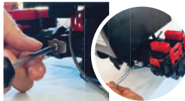
2 Mit beiliegenden Metallplättchen und Schrauben beidseitig befestigen
